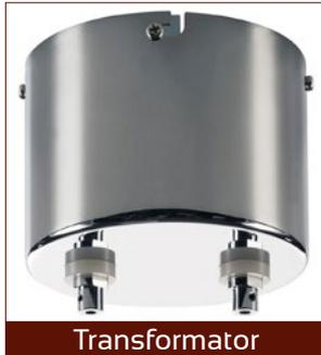
Für eine möglichst lange Lebensdauer der Leuchten sollte der Transformator mit mindestens 80% ausgelastet sein. Angenommen wir nutzen einen Transformator mit einer Leistung von 105 Watt, dann sollte die Last der Leuchten mindestens bei 84 Watt liegen.
